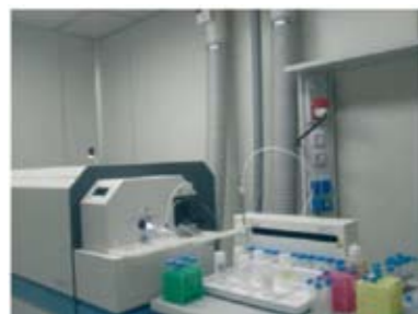
Fig.3 - Analisi dei campioni di acqua demi con HR-ICP-MS
