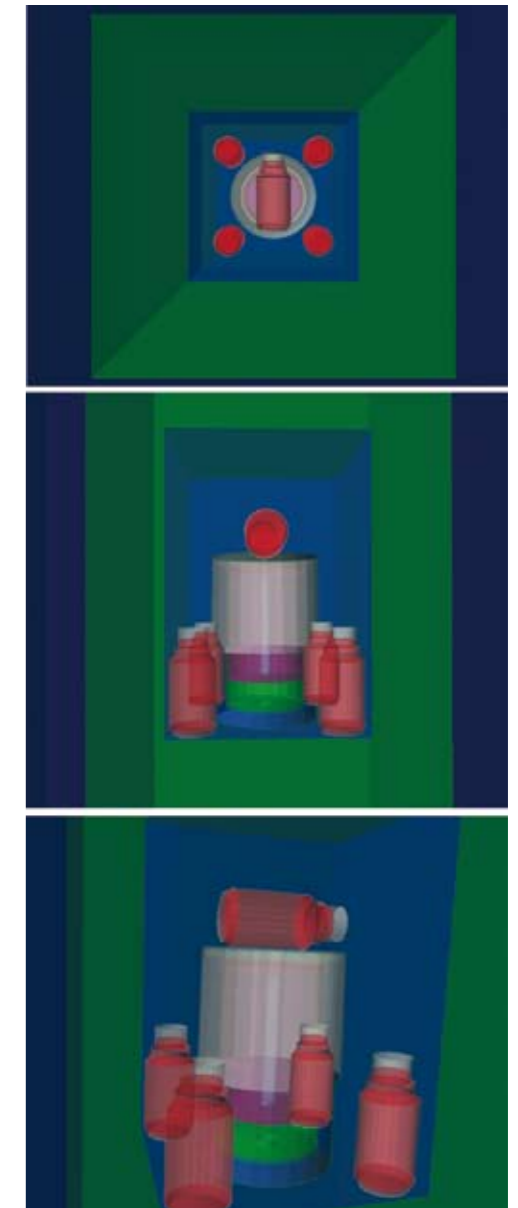
Figura 1: Esempio di geometria utilizzata in una delle simulazioni per la determinazione delle efficienze; come si può vedere in questo caso nel rivelatore a germanio sono state posizionate 5 bottigliette contenenti acqua. Quattro sono posizionate verticalmente ed una orizzontale direttamente sull'"naso" del rivelatore.
