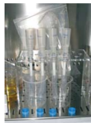
Figura 1 - Preparazione del campione con colonnine UTEVA
