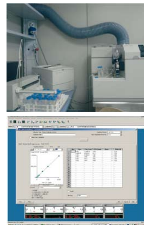
Fig.2- Analisi con ICP-MS quadrupolare ed acquisizione dei risultati
