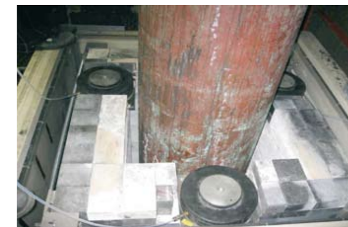
Figura 5: la foto mostra i tre smorzatori di vibrazione, nonché attuatori del sistema di verticalizzazione, installati sulla sommità della schermatura di piombo di CUORE-0.
