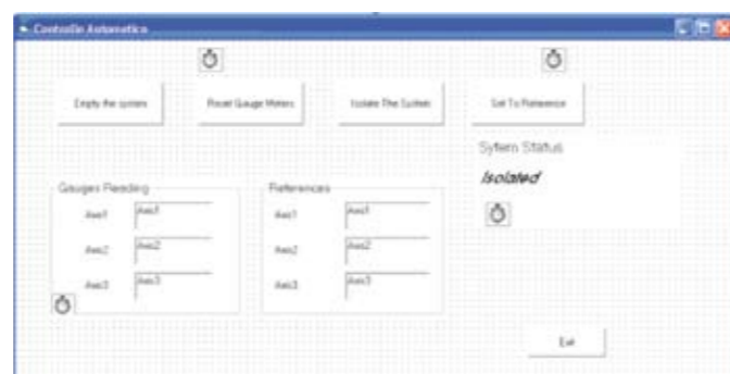
Figura 6: pannello per il controllo automatico del posizionamento del piatto di alluminio
